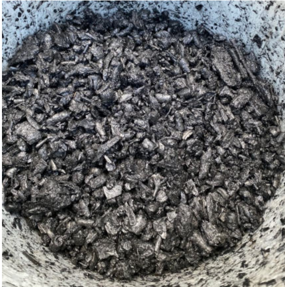
Bild 9: Im Pyrolyseofen selbst hergestellte Pflanzenkohle, unzerkleinert und frisch gelöscht (Foto: Feldmann)
